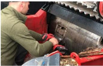
Messer leicht zugänglich für die Wartung durch vollständiges Öffnen der oberen Walze
